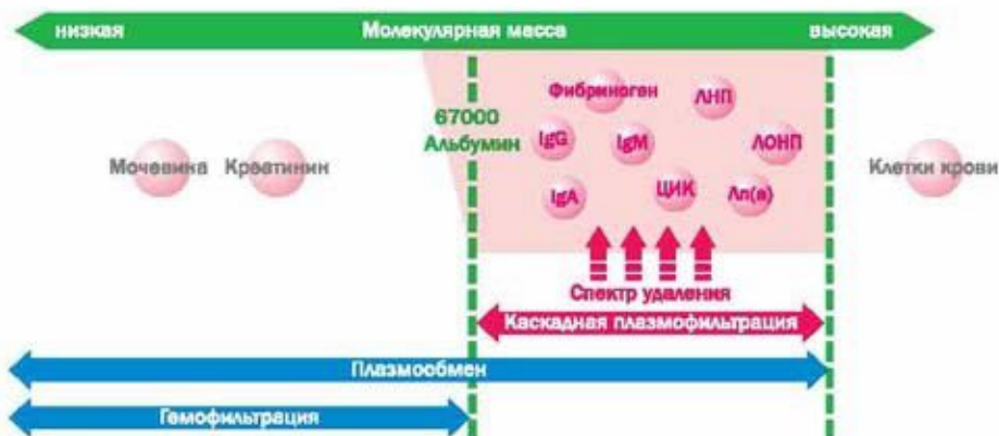
Рисунок 3. Принцип разделения компонентов плазмы на мембране фильтра Evaflix™.
